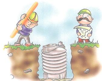
Die Schächte schrittweise mit Wasser erfüllen, und mit Sandes aufschüttend. **Von sukzessiven Schichten von 15-20 cm vorgehen**, mit Wasser dann mit kompaktem Sand anfangend.
