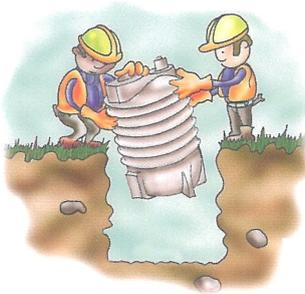
Verbinden und verschiedene Rohre testen, sich überzeugend, **daß die Lüftung frei ist**, um eine Depression in der Schacht zu vermeiden.
